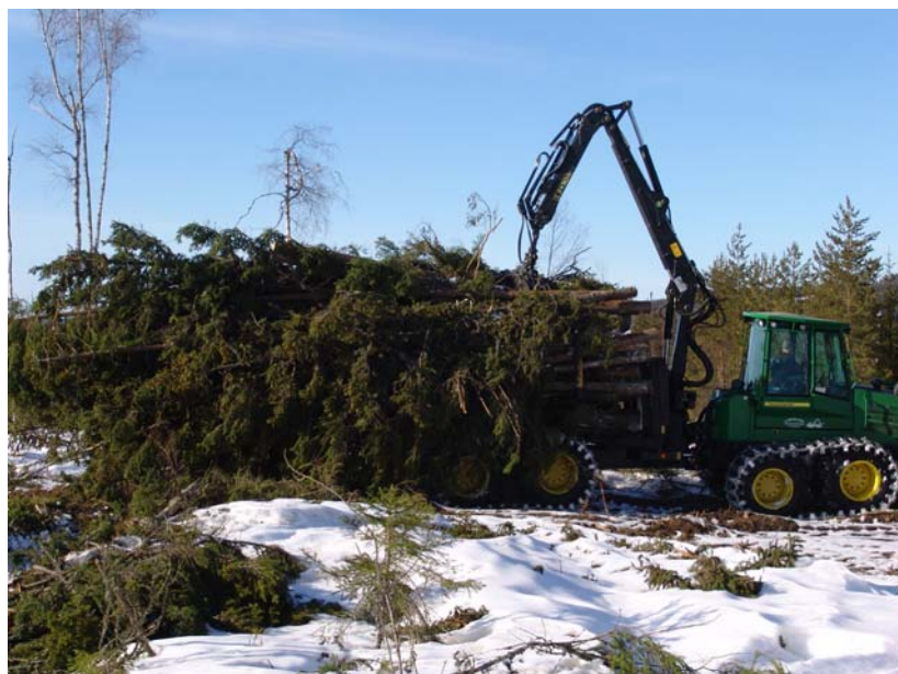
Figur 4. Prestationen vid skotning av långa toppar blir hög genom att man kan ta stora lass samt behöver färre uppställningsplatser och färre krancykler per lass.
