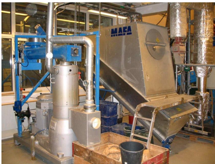
Figur 3. Pelletspress av märket Kahl med skruvmatare och blandare.
