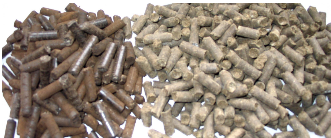
Figur 7. Pellets tillverkat från alternativa biobränslen, lignin och stallgödsel.
