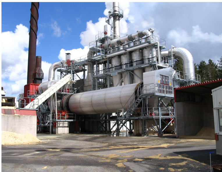
Figur 6. En roterande trumtork med återcirkulation av torkgasen och återvinning av kondensvärmnet.
