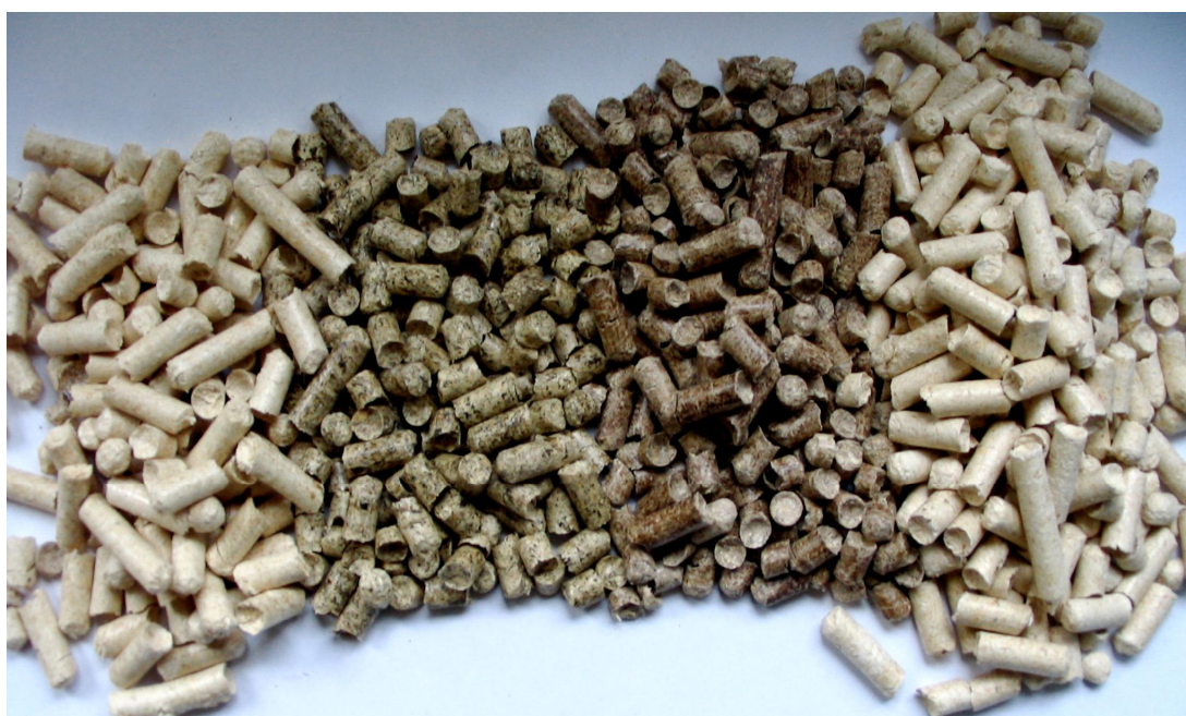
Figur 8. Pellets med tillsatser från vänster 3 % oxiderad majsstärkelse, 30 % raps, 3 % lignin, 3 % vetestärkelse tillverkad vid Karlstads universitet.
